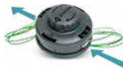
2 UMETNITE Umetnite nit u smjeru strelice „line in“ dok nit ne bude jednake duljine s obje strane
